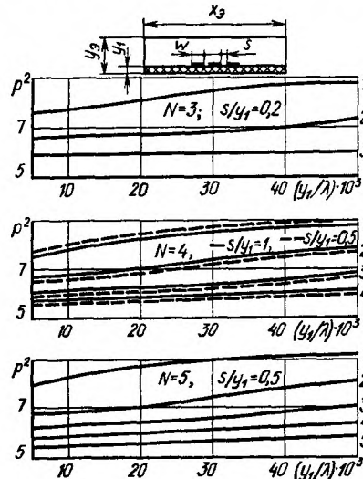
Рис. 1.27. Дисперсионные характеристики волн основных типов многопроводной МППЛ при y_2=7 ; x_2/y_1=20 ; \epsilon_1=9,8 ; w/y_1=1
